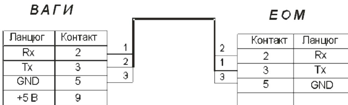
Рис. 1. Схема паяння кабелю для з'єднання ваг з ЕОМ.
